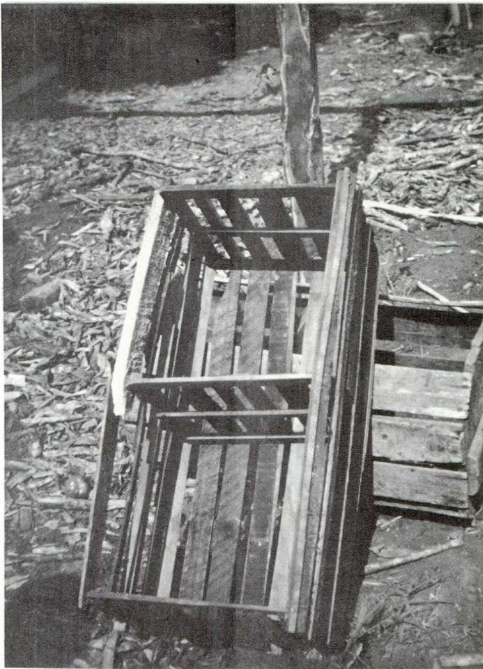
Foto No. 3 Huacal artesanal fabricado en la República Dominicana para la comercialización del tomate. Sus dimensiones no estandarizadas y su construcción inadecuada contribuyen a aumentar los daños durante el transporte y comercialización.
