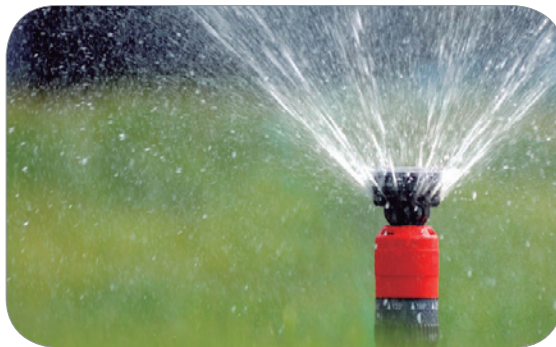
Figura 18a. Riego tipo microjet
