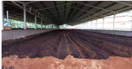
FOTO 08 | Leito de compostagem em estabilização.
