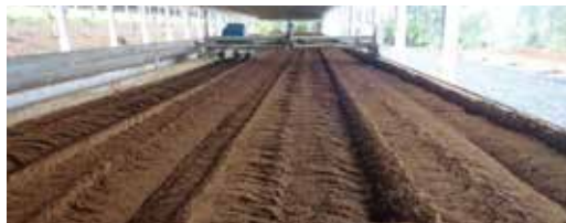
FOTO 07 | Leito de compostagem em estabilização.
