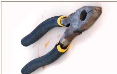
**Pinza:** sirve para sujetar los alambres.
