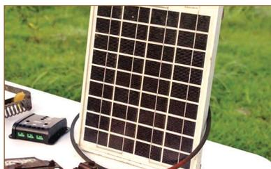
**Panel solar:** capta la energía eléctrica generada por la energía solar.
