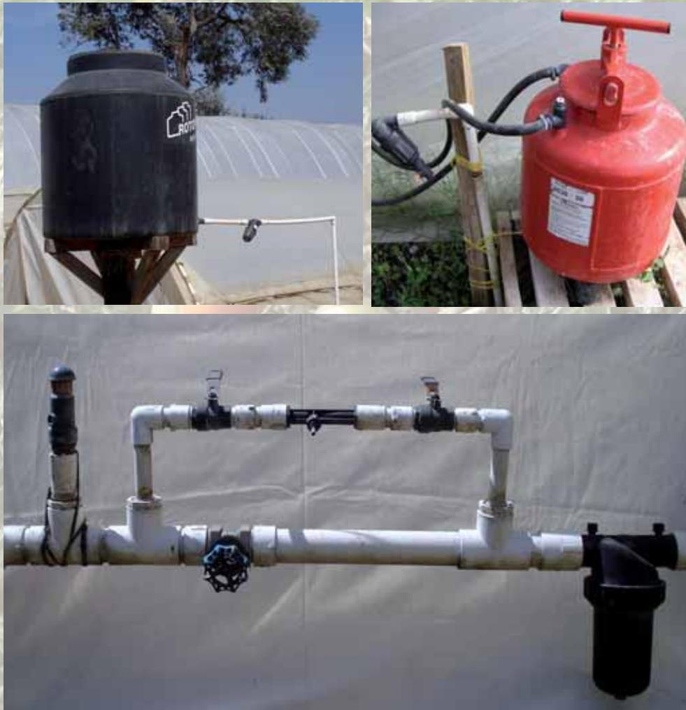
**Figura 10** Equipos de fertiriego.
