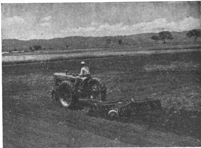
Fig. 21.3—La grada de discos movida por un tractor economiza el trabajo. Una grada con dientes de espigón fijada detrás de la otra dejaría un terreno bien preparado, listo para la siembra sin trabajo adicional. (Foto: U.S. Department of Agriculture).
