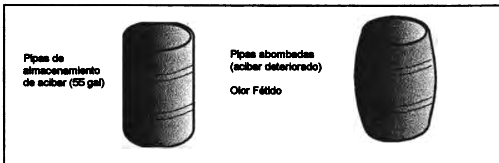
FIGURA 7: Pipas de almacenamiento y pipas abombadas (Acíbar deteriorado)
