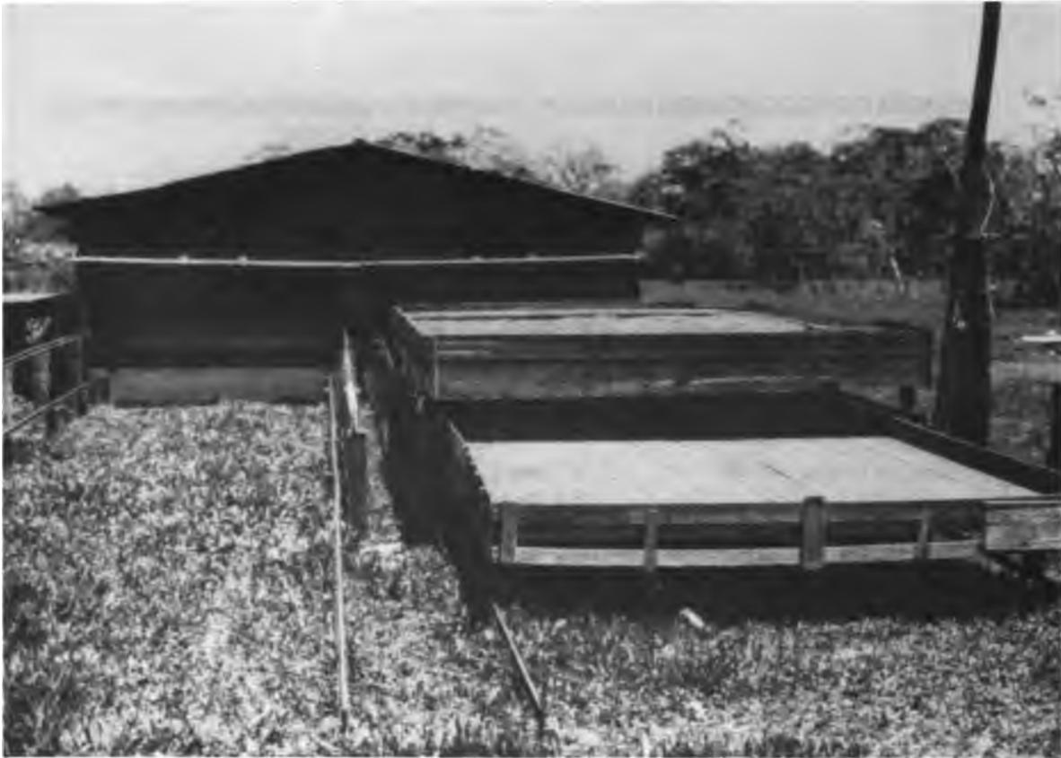
**Fig. 26. Secador solar de madera, ubicado en la finca “La Lola”, en zona atlántica de Costa Rica. Las cajas se mueven sobre rieles y en caso de lluvia, son guardadas fácilmente en la caseta construida para tal fin (R. Martínez).**
