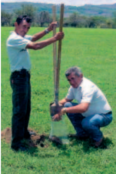
Toma de muestra de suelos en una finca propiedad de un usuario del Programa.
