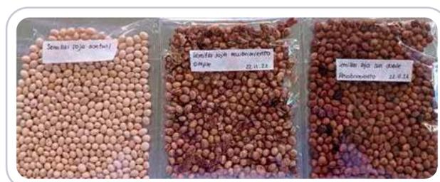
FIGURA 13. Recubrimiento de semillas de soja con el polímero de lignina. a) sin recubrimiento, b) con recubrimiento simple y c) con recubrimiento doble
