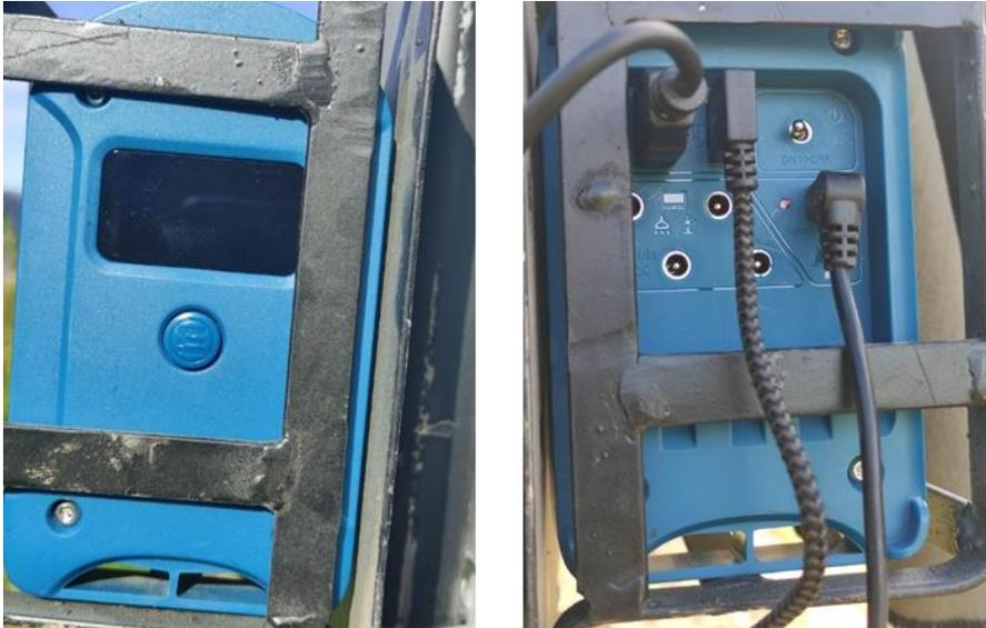
Estructura de seguridad para proteger la batería y permitir un fácil manipuleo de cableado
