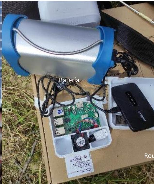
Para proteger a la nano computadora y sensores de la insolación directa o de la lluvia, se fabricaron coberturas por medio de impresiones 3D, tal como se puede ver en la siguiente fotografía:
