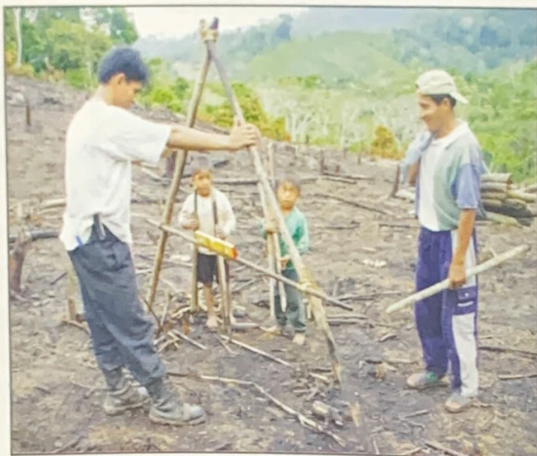
Figura 10. Trazado en curvas a nivel utilizando el caballete
