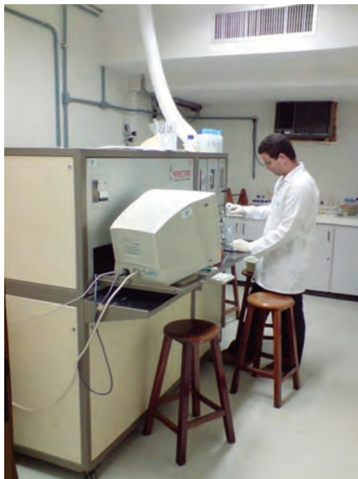
Figura 6 – Equipamento de ICP, da marca Espectro, modelo Spectroflame SVM3 , em operação no Laboratório de Geoquímica da UnB.
