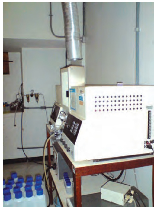
Figura 7 – Espectrofotômetro de Absorção Atômica, da marca Perkim Elmer, em operação no Laboratório de Geoquímica da UnB.
