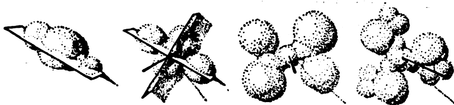
FIG. 20 — Grupos de átomos con distintos tipos de simetría. De izquierda a derecha: un plano de simetría, dos planos de simetría perpendiculares con un eje binario en su intersección, un eje binario y un eje ternario.
