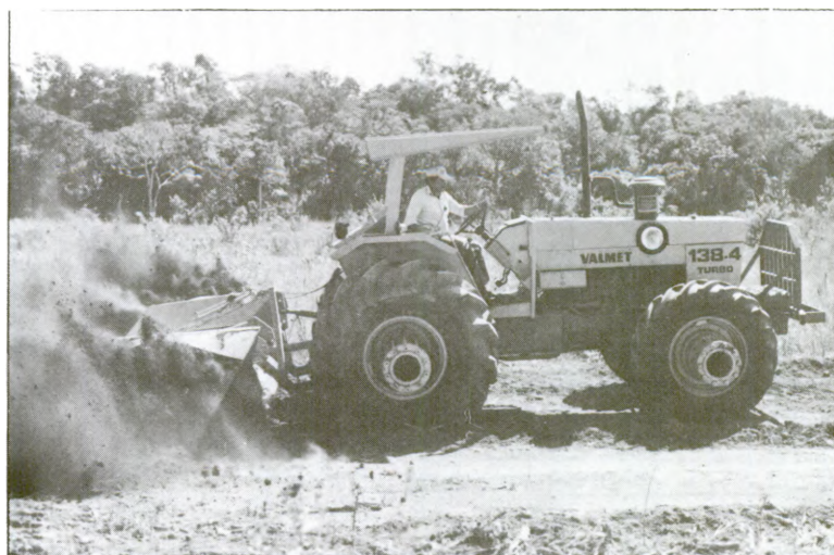
Vistas laterais da construção de canais e drenos pelo trator Valmet e valetadeira Dondi.
