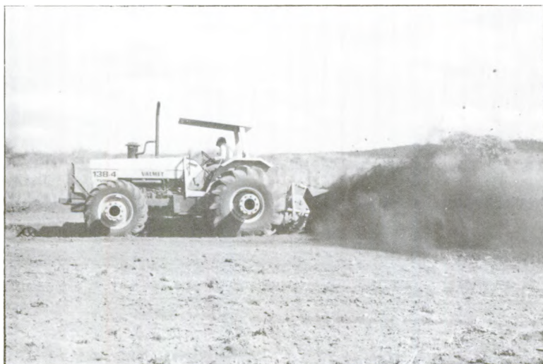
Vistas laterais da construção de canais e drenos pelo trator Valmet e valetadeira Dondi.
