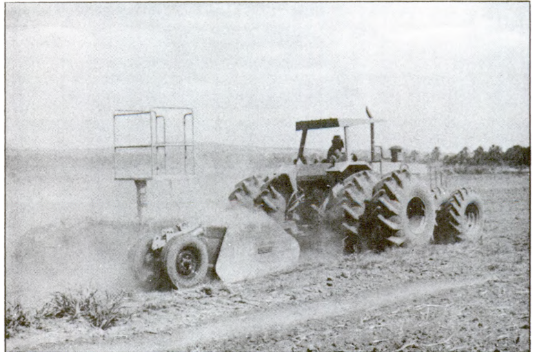
Vista das primeiras passadas para o "aplainamento" do terreno, no Setor II. Este terreno foi nivelado anteriormente por centróides. O trabalho do Valmet e da caçamba niveladora vai somente "ajeitar" o microrrelevo.
