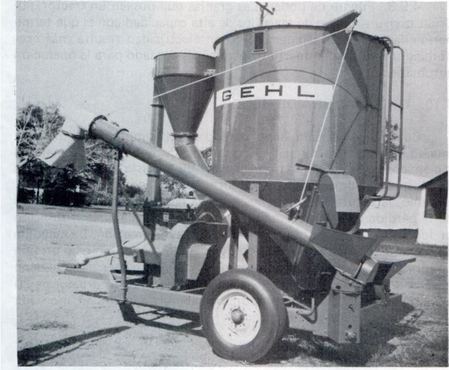
Fig. 74. Molino de combinación móvil, equipado con una mezcladora de forraje seco y un transportador helicoidal.
