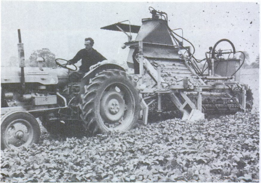
Fig. 14. Cosechadora de frijol que efectúa la separación de las vainas y hojas, pasando una sola vez por el terreno ( Mather y Platt ).
