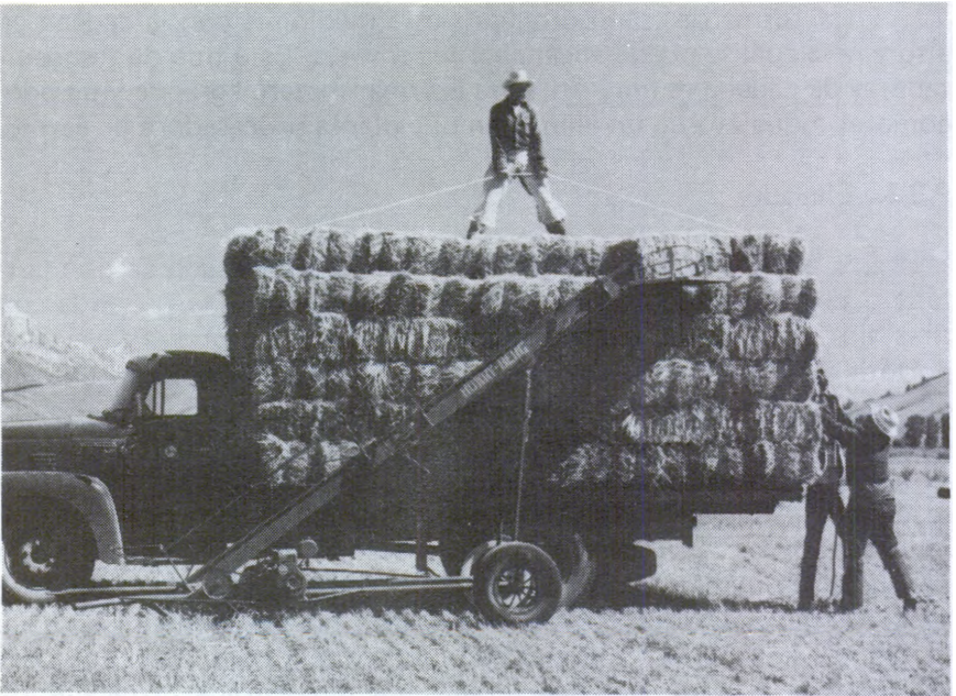
Fig. 127. Uso de un elevador portátil motorizado para cargar paca de heno en el campo (USDA).
