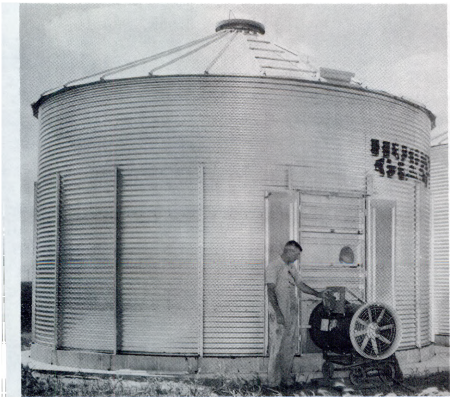
Fig. 89. Ventilador portátil utilizado para secar grano, por medio de la circulación de aire frío a través de un granero de acero (USDA).
