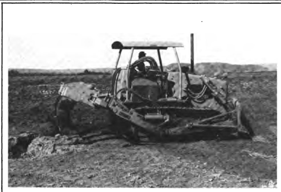
Início dos trabalhos de subsolagem.
