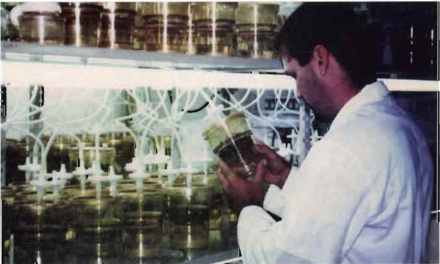
Foto 13-6. Cultivo en biorreactores simplificados de tipo "RITA®". El principio de este modo de cultivo en medio líquido se basa en la inmersión temporal del material vegetal. El sistema es automatizado. Se utiliza en el café para la producción masal de embriones somáticos a partir de la suspensión celular.
