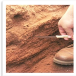
Figura 25. Ubicación de la compactación y forma de medir (Foto gentileza de F. Vallejos 2015)
