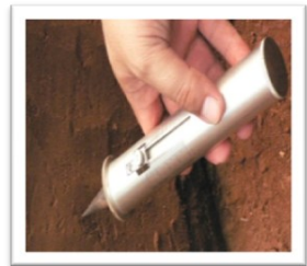
Figura 25. Ubicación de la compactación y forma de medir (Foto gentileza de F. Vallejos 2015)
