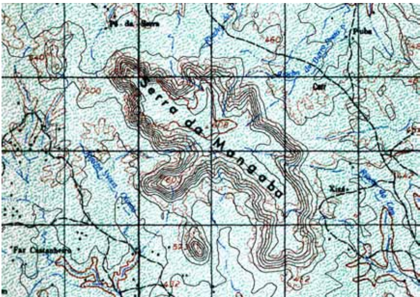
Figura 70 – Comparação entre curvas de nível da área da Serra da Mangaba. Curvas extraídas do SRTM: linhas pretas com equidistância de 20 metros. Curvas da Folha Gilbués: linhas avermelhadas com equidistância de 40 metros. Escala no monitor 1: 30.000. Escala aproximada da figura: 1: 60.000.
