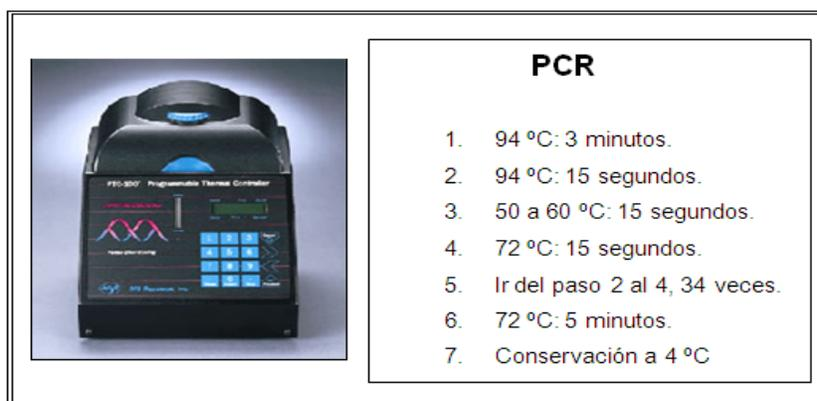
**Figura 5.** Perfil térmico utilizado para la amplificación de los marcadores microsatélites
