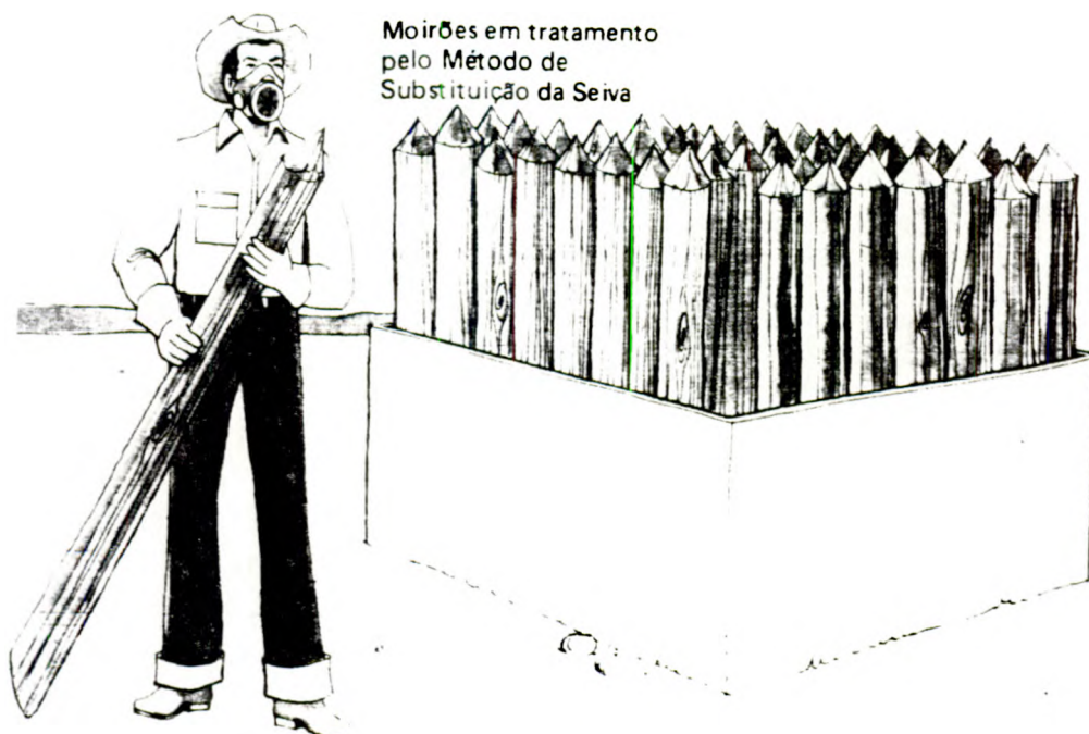
Figura 18- Moirões em tratamento pelo método de difusão ou substituição de seiva.
