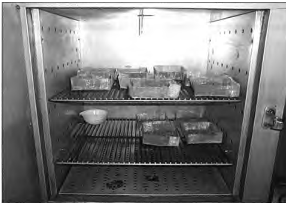
FIGURA 4.1 ACONDICIONAMIENTO DE MUESTRAS PARA EL SECADO EN ESTUFA SIN CIRCULACION DE AIRE
