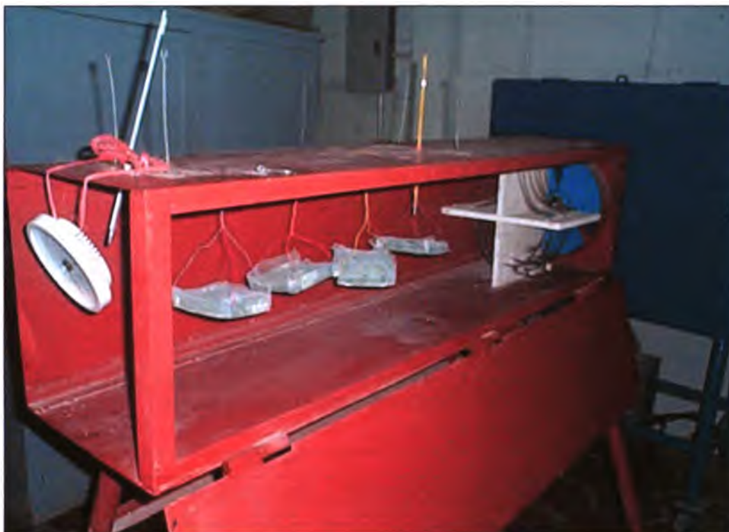
FIGURA 4.3 COLOCACION DE MUESTRAS EN EL SECADOR DE BANDEJAS CON CIRCULACIÓN DE AIRE
