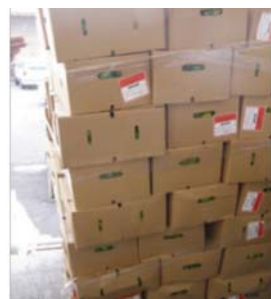
Cajas estibadas con patrón entrecruzado, colapsadas por el sobre peso
