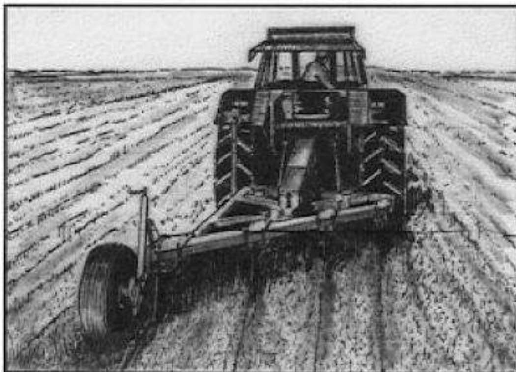
Figura 2. El Paraplow (adaptado de folletos comerciales)
