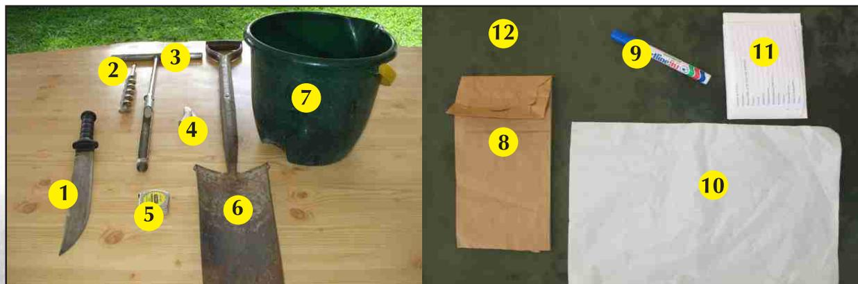
**HERRAMIENTAS:** 1. Corvo, 2. Barreno de espiral, 3. Barreno de tubo, 4. Navaja, 5. Cinta métrica, 6. Pala muestreadora, 7. Balde.
