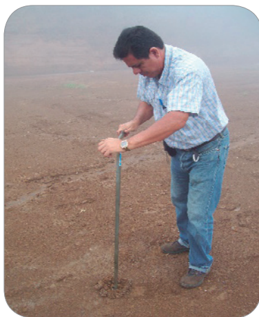
Figura 29. Toma de muestras de suelo con la ayuda de un barreno para efectuar el análisis de nutrientes.
