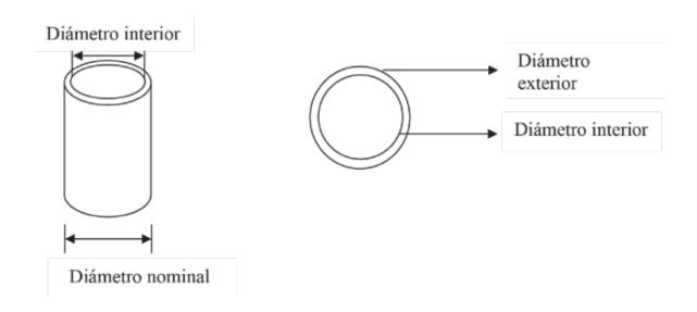
En un catálogo de tuberías, para un mismo diámetro nominal (diámetro exterior), existen tuberías de distinto diámetro interior ¿por qué es esto?
