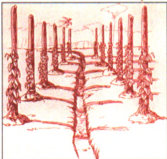
Sistema de drenaje (Manual del IBTA, Bolivia)
