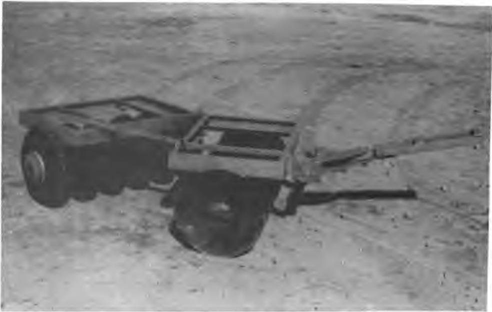
**Foto 4. Modelo de rastrillo embisagrado. Se destaca el ángulo de traba entre los dos cuerpos.**
