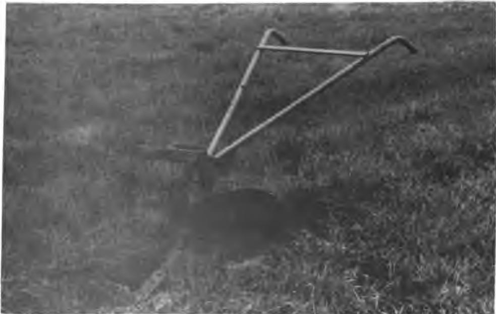
**Foto 5. Modelo de la surcadora diseñada en este proyecto.**
