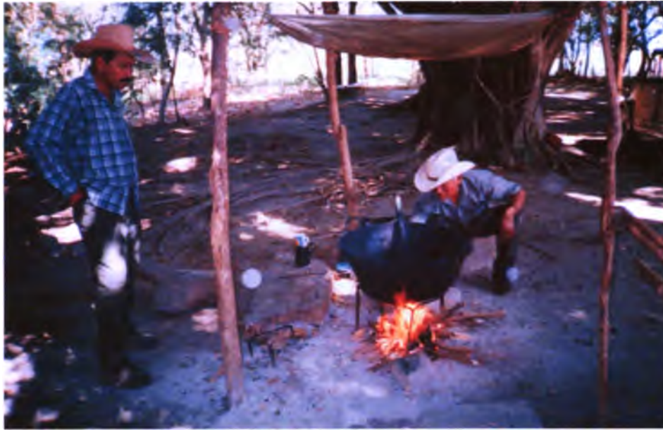
Fig. 18. La pasta de añil se somete a cocción para eliminar agua
