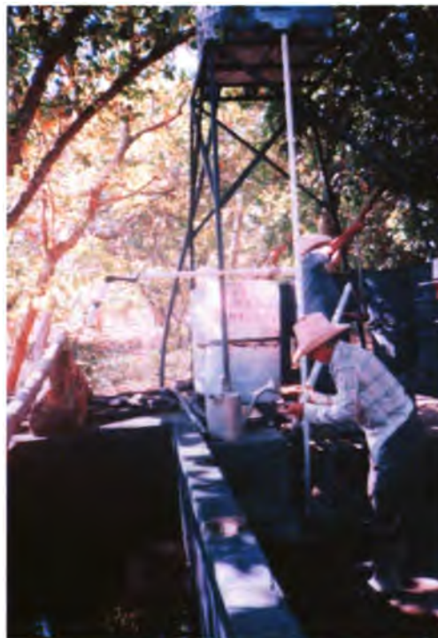
Fig. 14. Eliminación del agua residuo que queda del proceso de sedimentación por medio de un sifón, en el procesamiento en barriles
