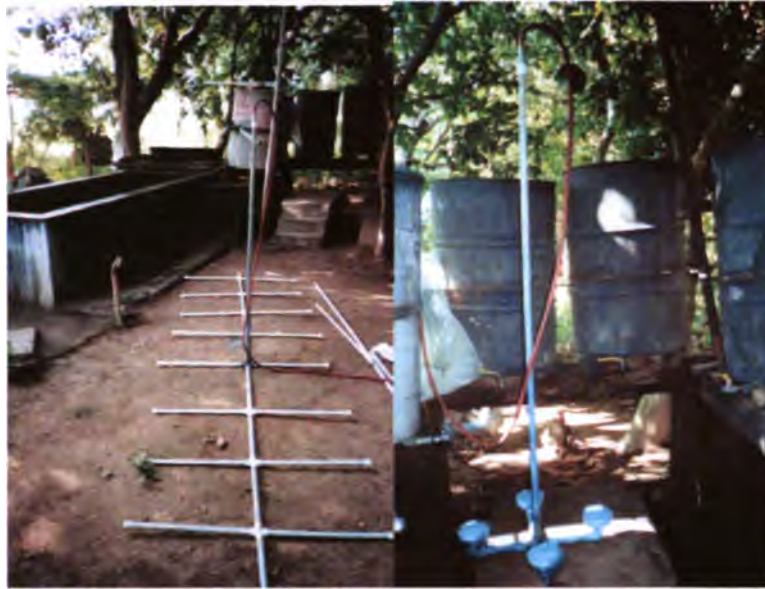
Fig. 26, 27 Modelos de dispersores para pila (forma de espinazo) y barril (duchas)
