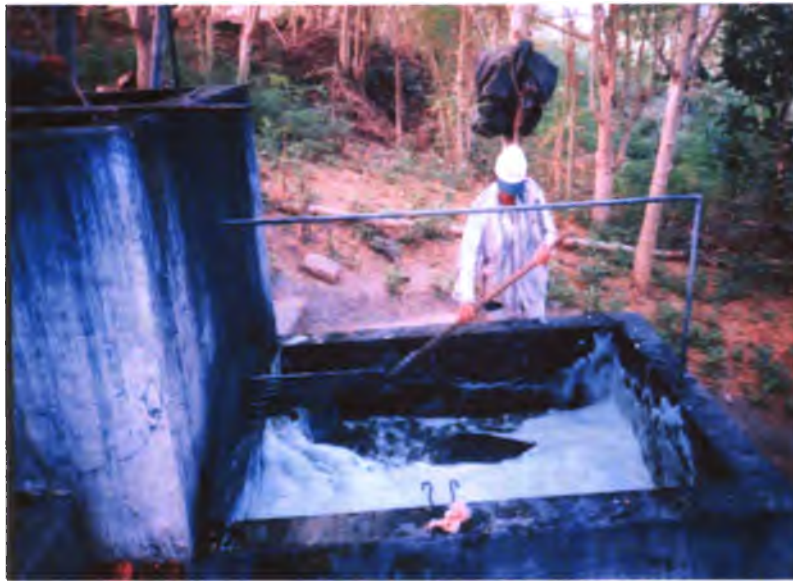
Fig. 13. Para la oxigenación se agita la solución obtenida de la maceración, con una paleta que tiene un guacal plástico en el extremo con un movimiento de vaivén horizontal
