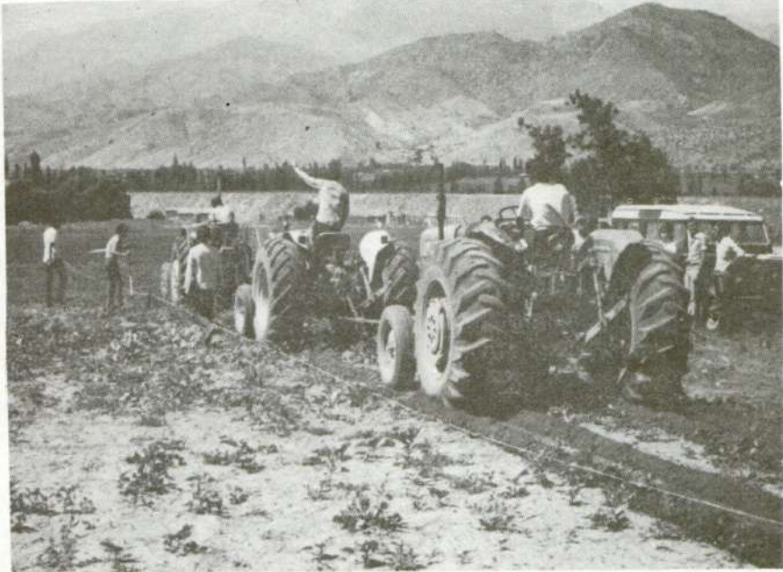
Fig. 242. Realización de una prueba de fuerza en la barra de tiro de un tractor. Los dos últimos tractores sirven para frenar al primero bajo prueba (véase Fig. 243).
