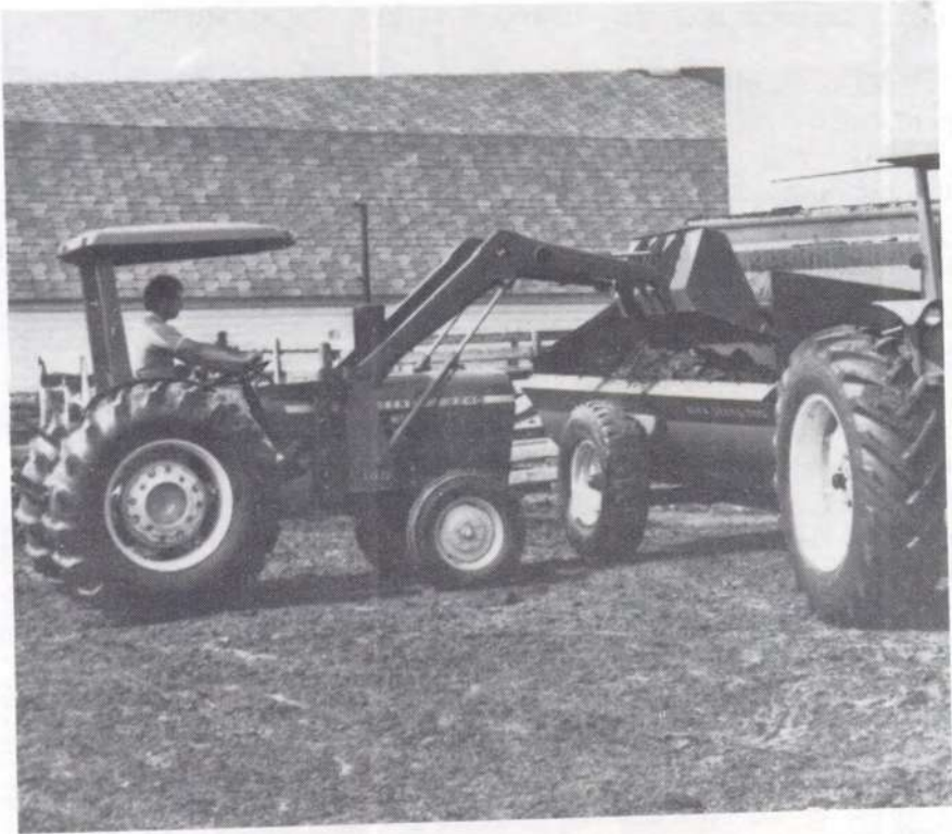
Fig. 106. Un cargador frontal convencional utilizado como accesorio de un tractor agrícola (John Deere - Ponce Yepes, Quito).
