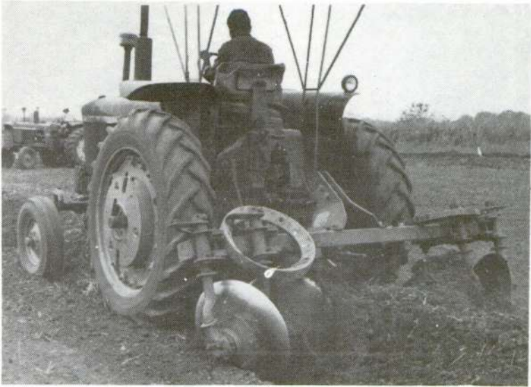
Fig. 99. Uso de discos para la formación de camellones entre arrozales.
