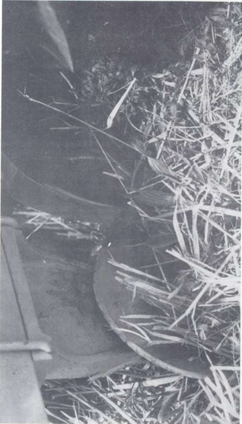
Fig. 87. Un abresurco de triple disco que permite cortar la vegetación superficial durante la siembra con cero labranza (véase también las Figs. 133 y 141).
