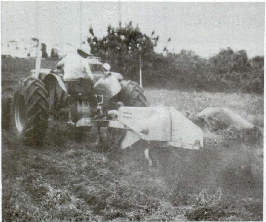
Fig. 251. Una cavadora de papas con cadena elevadora sinfín, que limpia los tubérculos dejándolos en la superficie para su recolección a mano (véase también Fig. 85).
