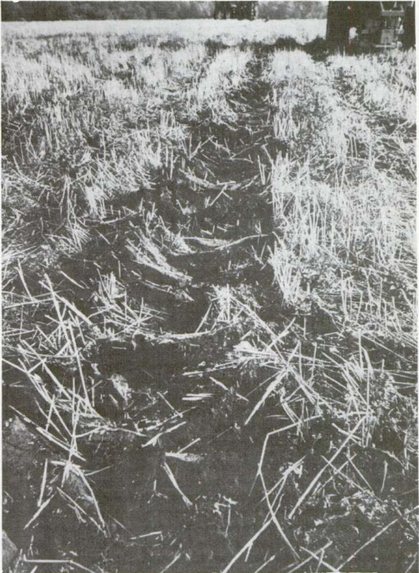
(c) Huella después de una prueba de patinaje, aumentado gradualmente de cero (abajo) hasta 100 % (arriba).
