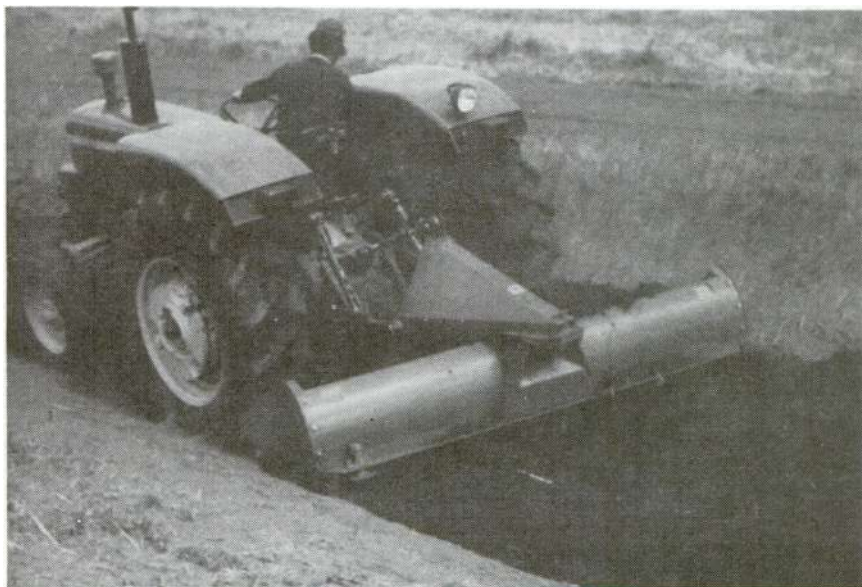
Fig. 105. El uso de una hoja niveladora trasera facilita los movimientos menores de tierra.
