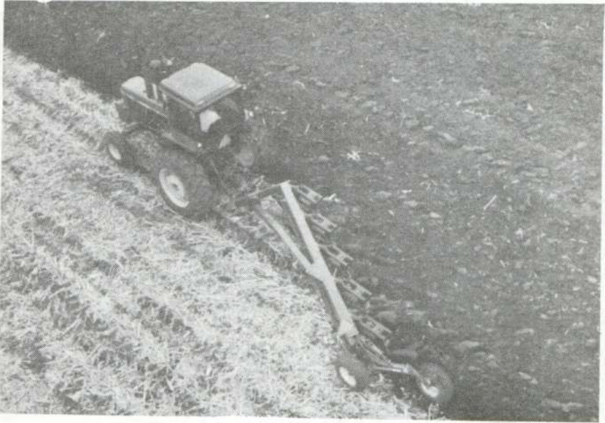
Fig. 158. Acople semintegral de un arado de vertedera ( John Deere – Ponce Yepes, Quito).
