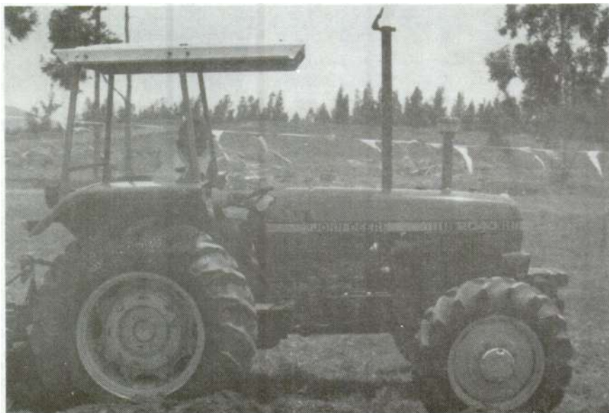
Fig. 229. Tractor convencional adaptado para uso con doble transmisión. Aunque su distribución de peso no es óptima, se puede esperar un aumento en la tracción y en el rendimiento.
