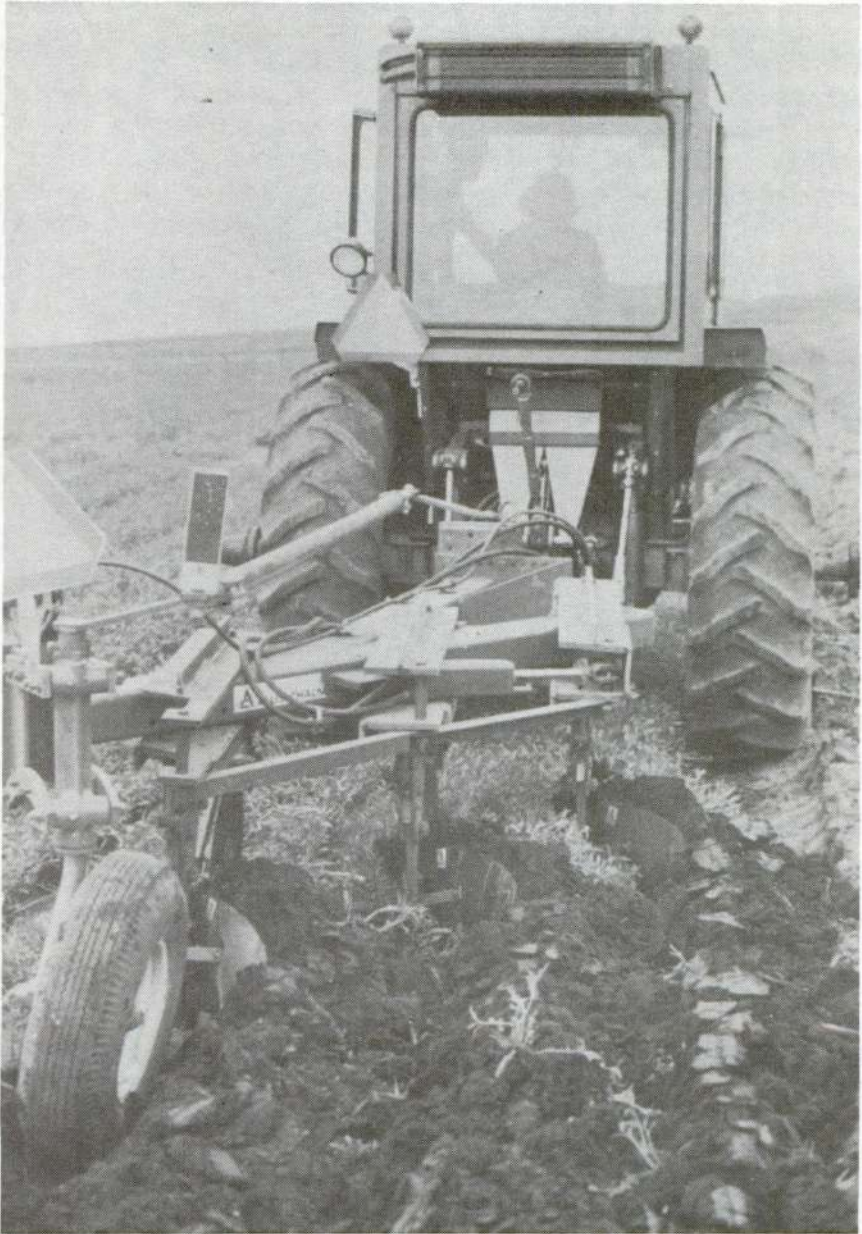
Fig. 52a. Un arado de vertedera experimental que permite cambiar la inclinación de los cuerpos hidráulicamente, durante el trabajo ( National Institute of Agricultural Engineering, Silsoe, Bedford, Inglaterra ).
