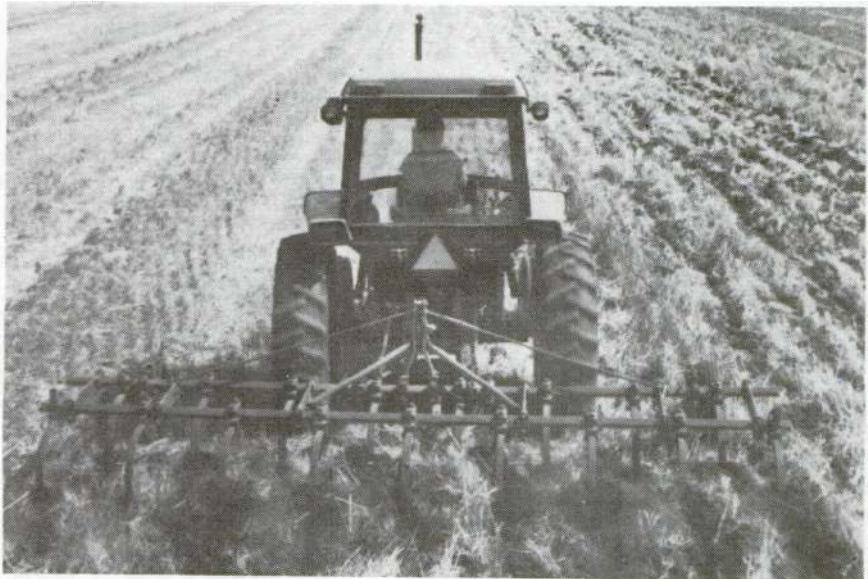
Fig. 64. El uso de cincelos de resorte en la forma de 'C' para provocar el estallamiento y mullimiento del suelo. La materia orgánica queda en la superficie formando una capa protectora (John Deere -- Ponce Yepes, Quito).
