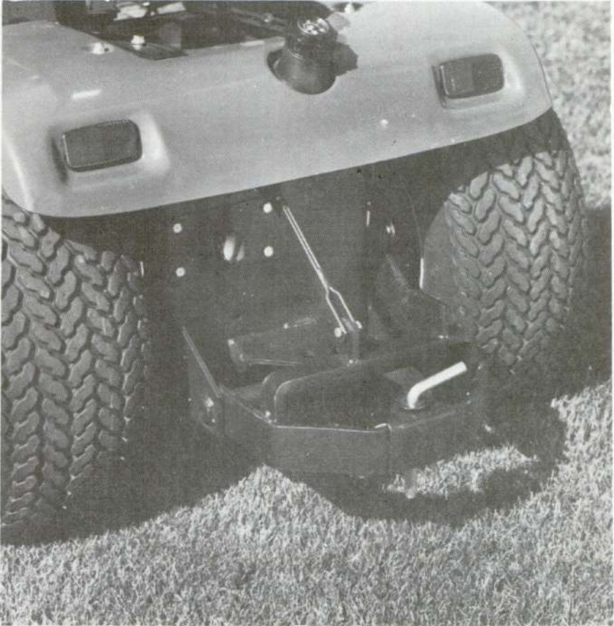
(c) Acople por un solo punto en un tractor jardinero ( John Deere, Moline ).
