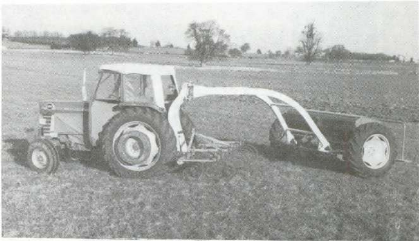
(b) Puente diseñado para permitir la combinación de varias labores con herramientas convencionales. Trabajan un cultivador de dientes y una sembradora (NIAE, Silsoe, Bedford, Inglaterra).
