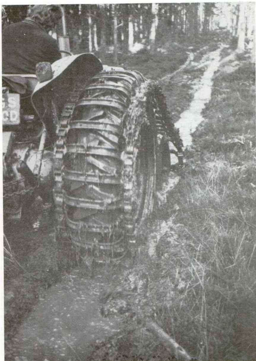
(b) La semioruga provee una mayor flotación y tracción en condiciones difíciles.
