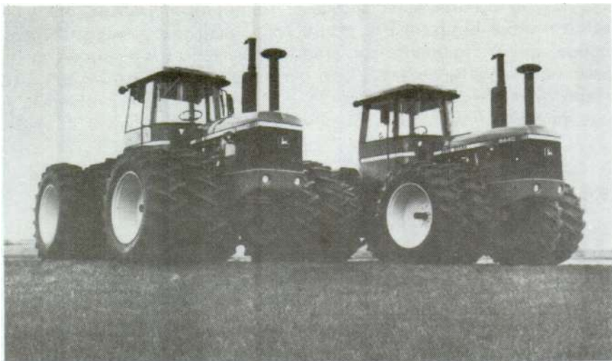
Fig. 228. Dos distintos modelos de un tractor moderno de alta potencia y diseño óptimo en la distribución del peso, para aprovechar su doble transmisión ( John Deere - Ponce Yepes, Quito).
