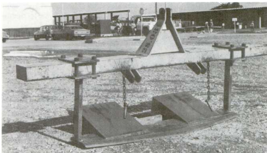
Fig. 84. Herramienta desarrollada en CIAT (Colombia) para efectuar un corte horizontal, luego soltar el suelo alrededor de dos hileras de tubérculos de yuca con los platillos inclinados a 17^\circ . Los tallos son previamente cortados con machete o un rozador giratorio y la cosecha se hace a mano (CIAT, Cali, Colombia).
