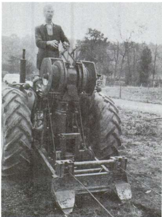
Fig. 117. Anclaje que permite la operación de una 'wincha' de doble cable, atrás de un tractor agrícola ( James Jones and Sons Ltd, Larbert, Escocia ).
