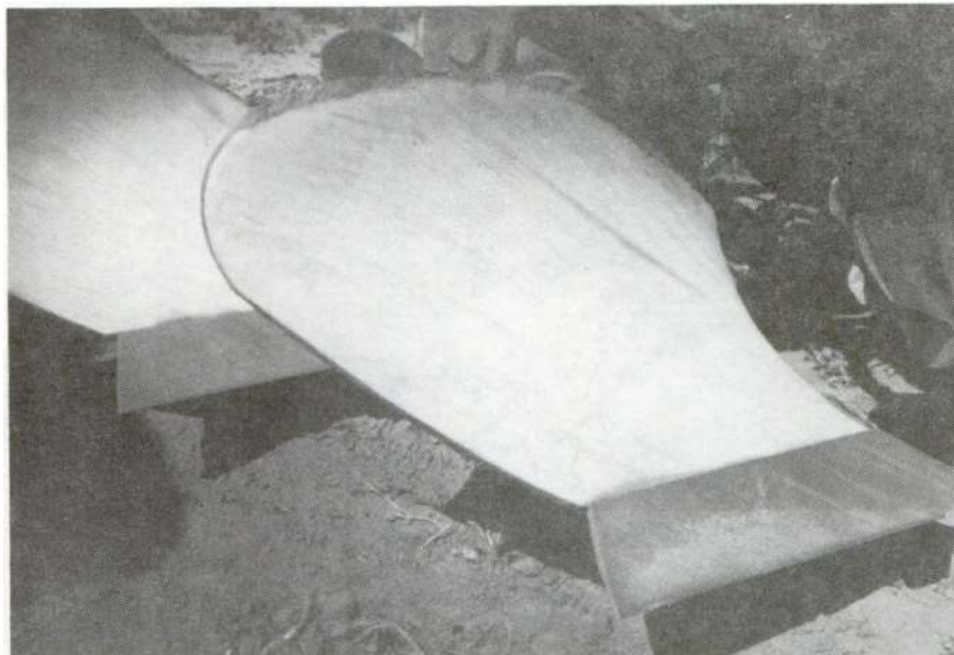
Fig. 36. Un cuerpo de vertedera cubierto con una lámina de PTFE para reducir los efectos de adhesión en un suelo plástico y mejorar el restregamiento ( National Tillage Machinery Laboratory, Auburn, Alabama, EUA ).
