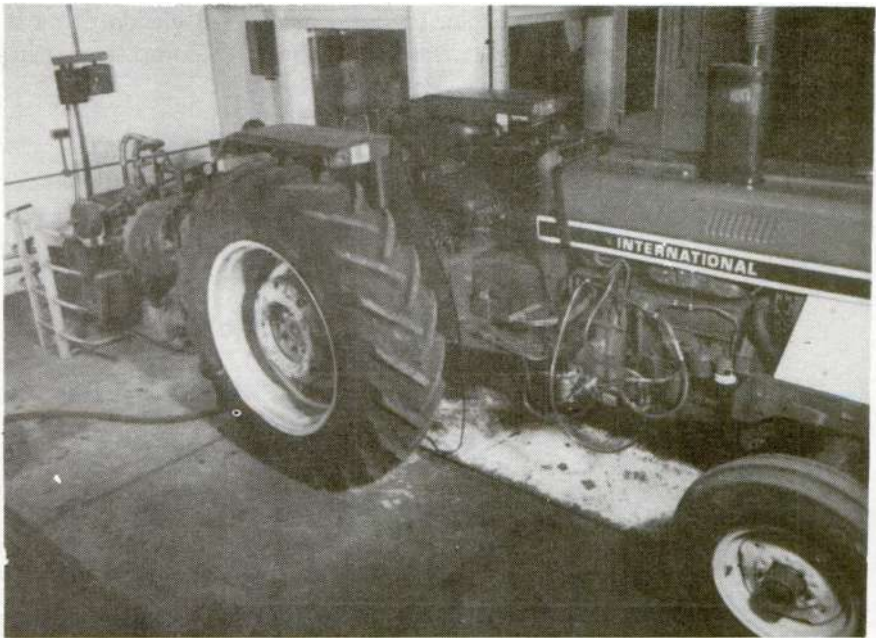
Fig. 239. Prueba internacional de la potencia en el eje de toma de fuerza (NIAE, Silsoe, Bedford, RU).
