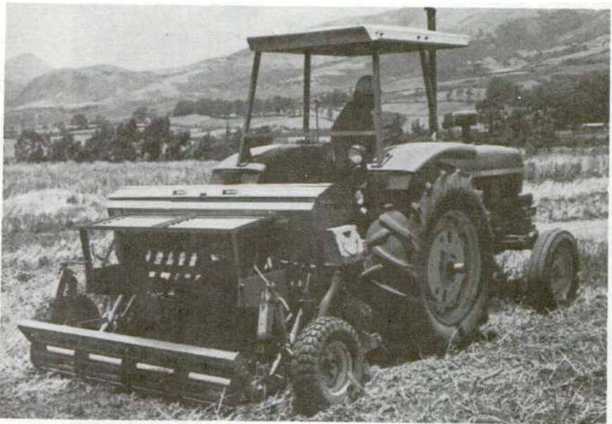
Fig. 139. La herramienta de labranza reducida permite romper el suelo con un cultivador giratorio; sembrar y compactar la cama con un rodillo en un solo paso.
